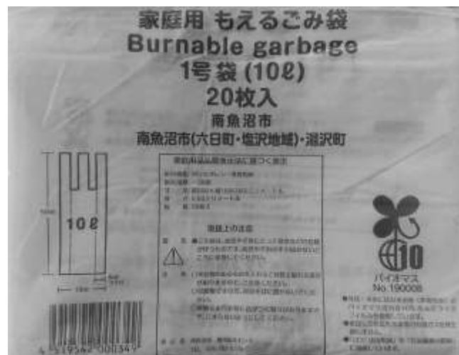
写真 3．インフレーション成形サンプル（南魚沼市ゴミ袋）
