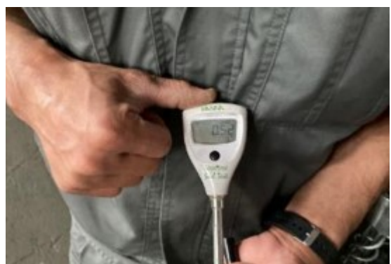
写真-6 芯温の測定
