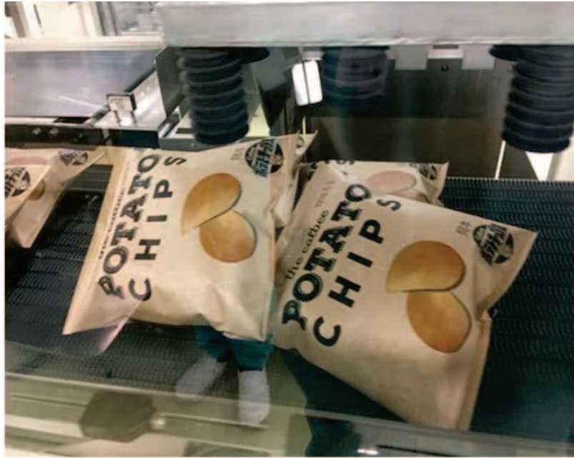
図1 袋製品を集積するコンベヤでの滑り
