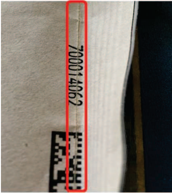
図3 縦シール裏側の傷
