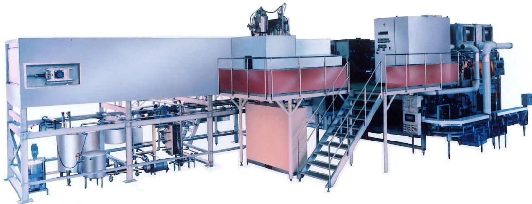
写真 1 : MT-30E 機 (木綿とうふ製造機)
