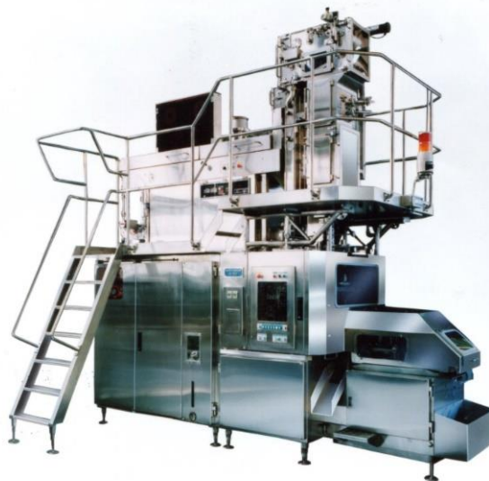
写真 3：ロールフェッド紙容器成形無菌充填機 UP-FUJI-MA60
