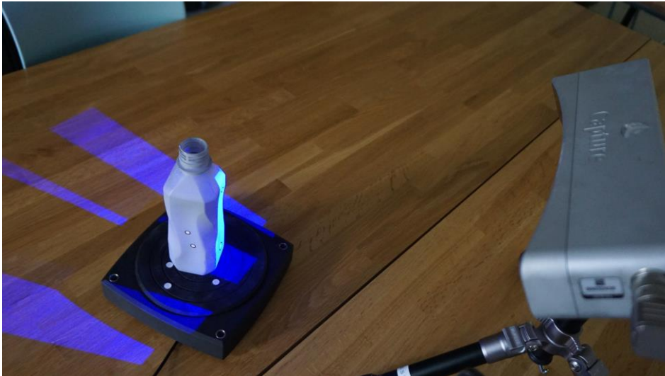
図 1 Geomagic® Capture™による測定のイメージ
