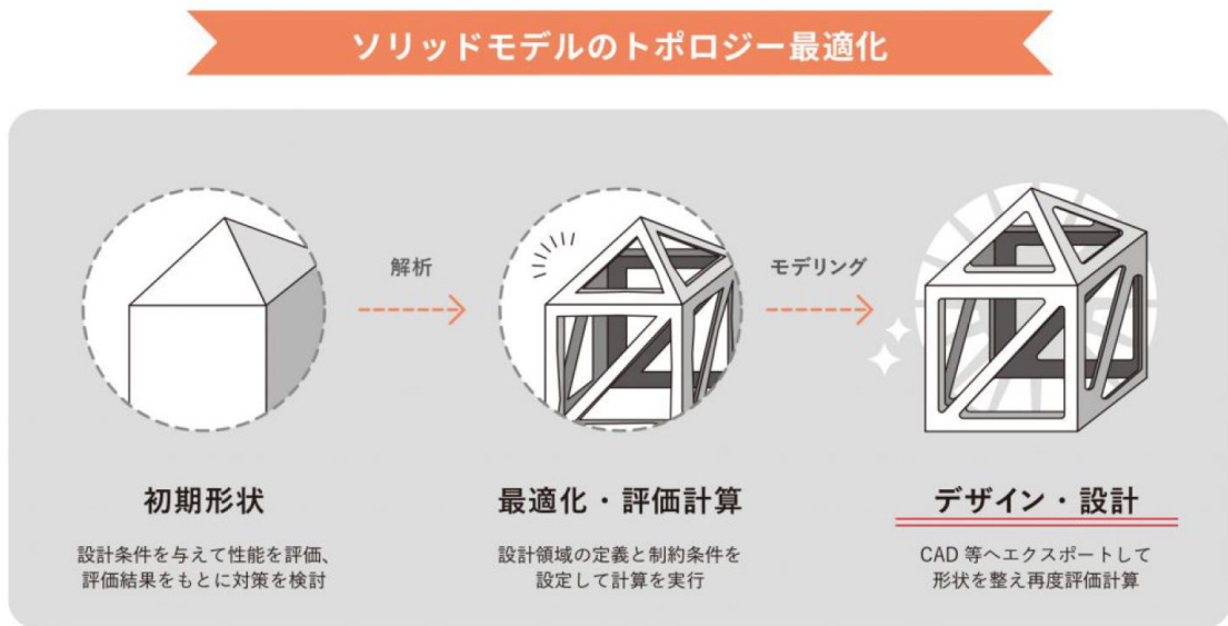
図 13 ソリッドモデルのトポロジー最適化イメージ
