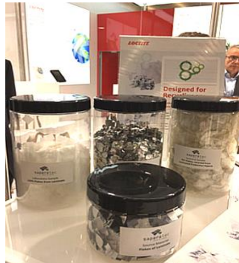
写真6 複合材料 PET/Al/PE を各素材に剥離・分離する Saperatec 技術
