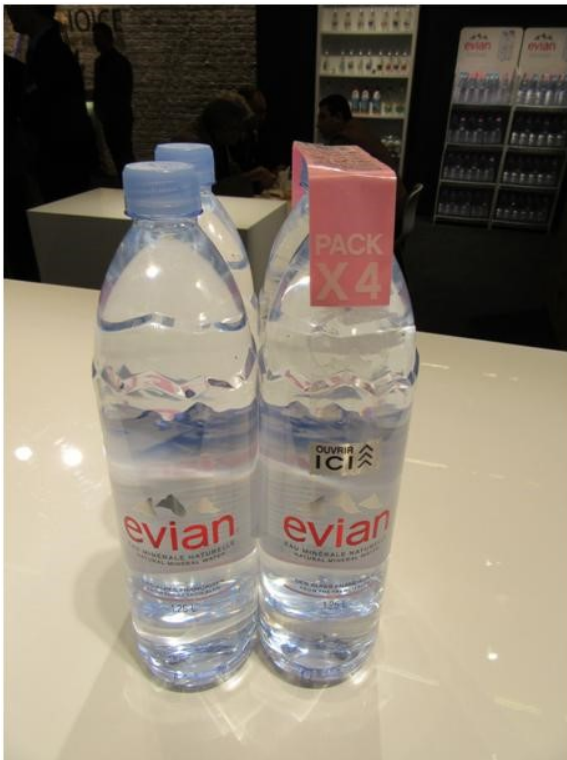
写真 7:ホットメルトの特殊糊でボトルとボトルを直接接着した4本マルチパック。ボトルはネジルようにして簡単に剥がせる。
